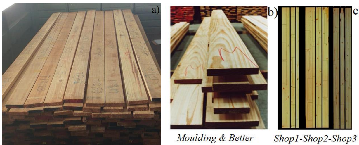
Figura 3. Tablas aserradas (a), Tipificación de la madera en grados de calidad Factory : cortes con aptitud para molduras y productos superiores (b) y cortes con aptitud para puertas y ventanas (c) Figure 3: Sawn boards (a), classification of wood in quality grades Factory : Cuts suitable for moldings and superiors' products (b) and boards suitable for doors and windows (c).
